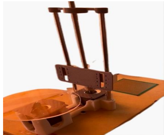
Figura 3. Ensamble de partes impresas y ejes. La base se unió a la cama fija, se procedió a color los motores nema 17 a los zócalos de la base, se colocaron los ejes y el carro se sujetó usando dos de los cojinetes, así mismo se colocó el soporte superior, para proveer estabilidad en el desplazamiento.
