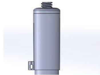
Figura 3. Visualización de mástil retraído hasta la base (Vista lateral de escoba retráctil).
