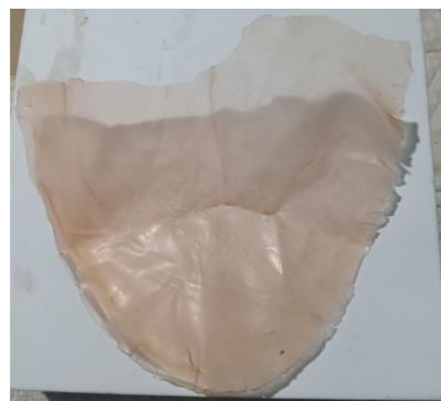
Figura 5. Lámina regresando a su estado original sin ninguna ruptura
