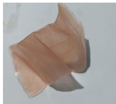
Figura 4. Lámina maltratada y arrugada
