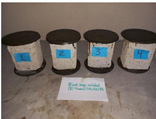
Imagen 1. Muestras de block de concreto macizo de baja calidad.
