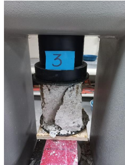
Imagen 4. Muestras de block de concreto macizo de baja calidad en ensayo de compresión simple
