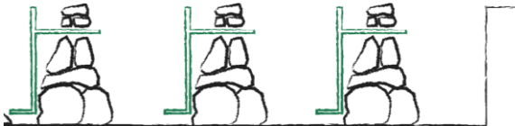
Imagen 35. Instalación de tubería en cámaras. Fuente: Elaboración propia.
