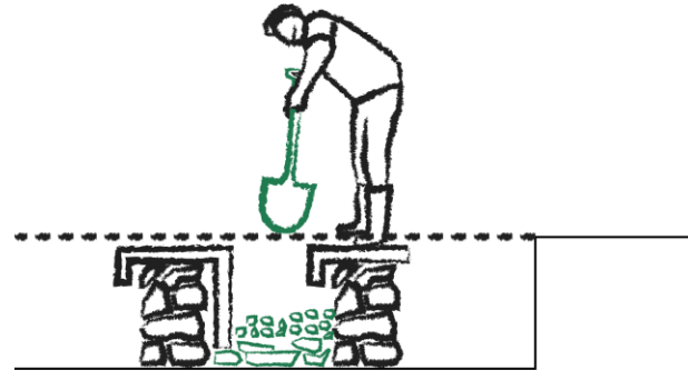
Imagen 42. Colocación de material para filtrado en humedales artificiales. Fuente: Elaboración propia.
