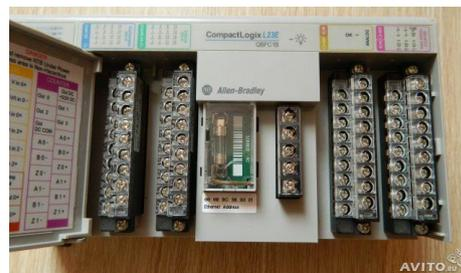
Figura 3. Controlador Lógico Programable, PLC.
