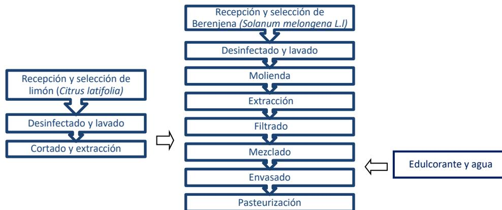
Figura 2. Diagrama del proceso de preparación de la bebida de berenjena.
