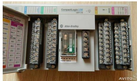
Figura 3. Controlador Lógico Programable, PLC.
